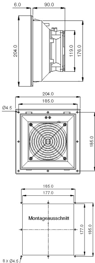
Bohrungen nur bei Schraubbefestigung
